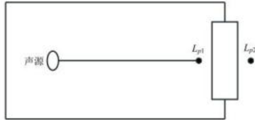
图 4.22 室内声源等效为室外声源图例
